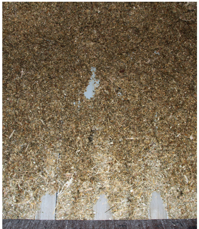
Grovfodermagasinerne er designet med vandret lagring og udstyret med det såkaldte Moving Floor system, der hindrer iltning af foderet og sikrer, at det ældste foder bruges først. Foto: Simone Balthzersen.
