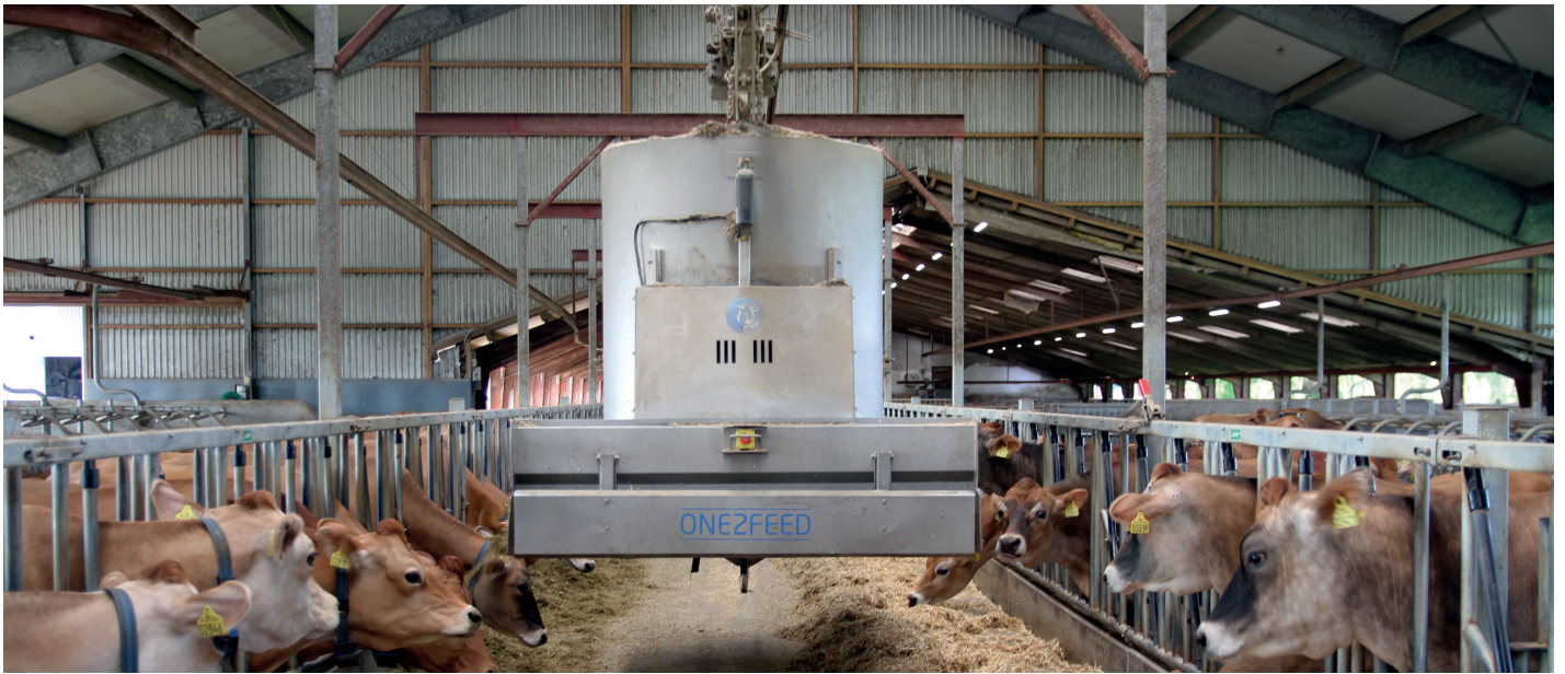
Mixervognen er fuldautomatisk og sørger selv for afvejning, blanding og udfodring, samt indskubning af foder på foderbordet. Foto: Simone Balthzersen.
